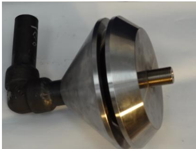
Pre-ensamble cono de inyección
